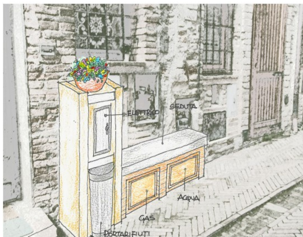
Seduta in pietra con basamento per alloggiamento contatori
